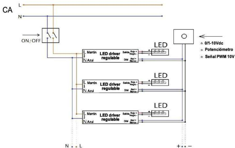
Conexão para regulação por dimmer on / off 0-10V:
