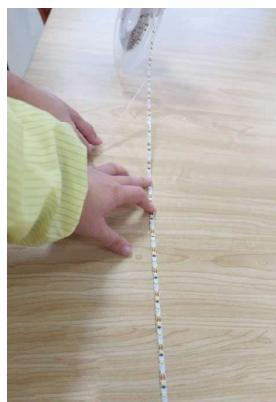
Se possível, a fita deverá ser aplicada por duas pessoas em simultâneo de forma a assegurar o correto percurso da fita e remoção da fita adesiva.
