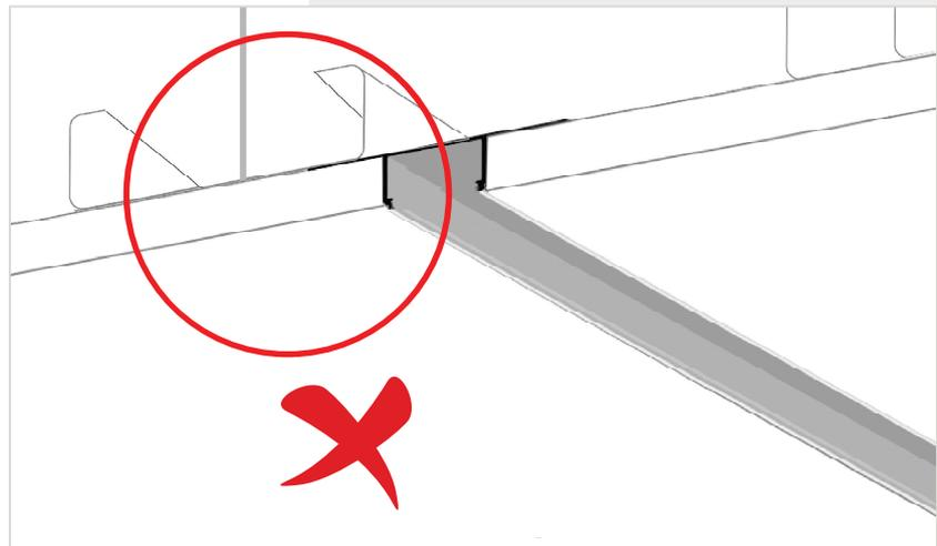
\_ Não aplique o perfil de iluminação entre a placa de gesso e o respetivo perfil de teto de afixação, deixando uma distância mínima superior à largura da aba (20mm)
