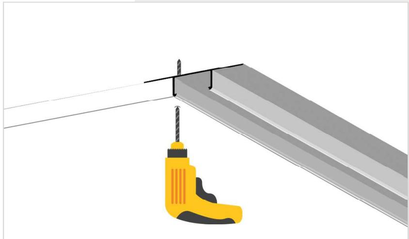
**2**\_ Depois de passar o cabo da fonte de alimentação, aplique o difusor técnico de obra reutilizável, para a proteção do perfil durante a montagem.
