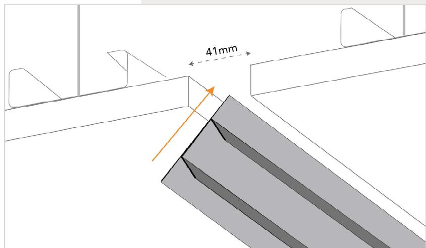
**C\_** Aplique um parafuso no comprimento do perfil de forma a dar suporte para o segurar e puxar para baixo, contra as placas de gesso
