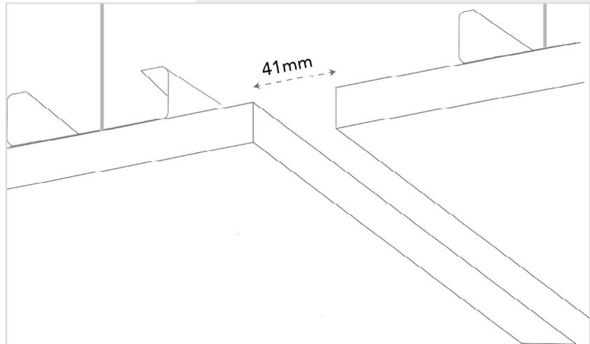
**B\_** Incline o perfil de forma a passá-lo entre as duas placas de gesso
