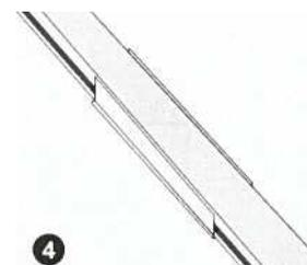
4 Aplique a faixa de neon completamente aos clips de fixação. A superfície fita led deve estar paralela à borda superior do clip de fixação.
