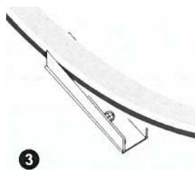
3 Coloque a superfície emissora de luz virada para cima e insira a fita de led nos clips de fixação.
