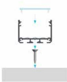
Manual de instalação do perfil ILEDO com tampa WIDE, com parafuso de fixação
