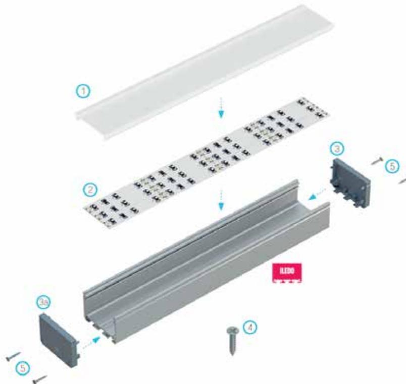
Esquema de montagem dos elementos do sistema de iluminação utilizando o perfil ILEDO e (1) tampa WIDE, (2) três fitas de LED, (3) tampa de extremidade sem orifício, (3a) tampa de extremidade com orifício, (4) parafuso de montagem, (5) parafusos de montagem das tampas de extremidade
