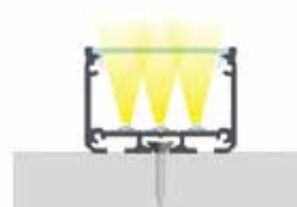
Resultado final da montagem do perfil ILEDO com tampa WIDE, com parafuso de fixação
