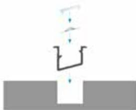
Instruções de instalação para o perfil de encastrar V com uma tampa BASIC
