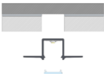
Manual de instalação do perfil GAUDI com cobertura BASIC, ranhura montada entre as duas placas de gesso cartonado
